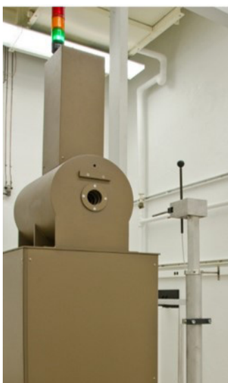
الشكل 6-9 مصدر السيزيوم 137 مستخدم في معايير القياس (اليسار) وفي جهاز معايرة أداة معدل جرعة الإشعاع CDV-794 (اليمين). المصادر: المعهد الوطني للمعايير والتكنولوجيا لمعايير المقاييس ووزارة الصحة في فلوريدا لمعايير أداة معدل جرعة الإشعاع.
