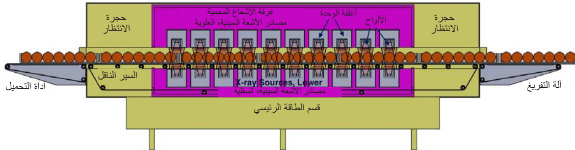
الشكل 5-5 مصدر الأشعة السينية باللوحة المسطحة لتقنية الحشرات المعقمة.
