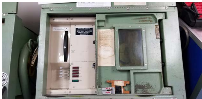
الشكل 6-9 مصدر السيزيوم 137 مستخدم في معايير القياس (اليسار) وفي جهاز معايرة أداة معدل جرعة الإشعاع CDV-794 (اليمين). المصادر: المعهد الوطني للمعايير والتكنولوجيا لمعايير المقاييس ووزارة الصحة في فلوريدا لمعايير أداة معدل جرعة الإشعاع.
