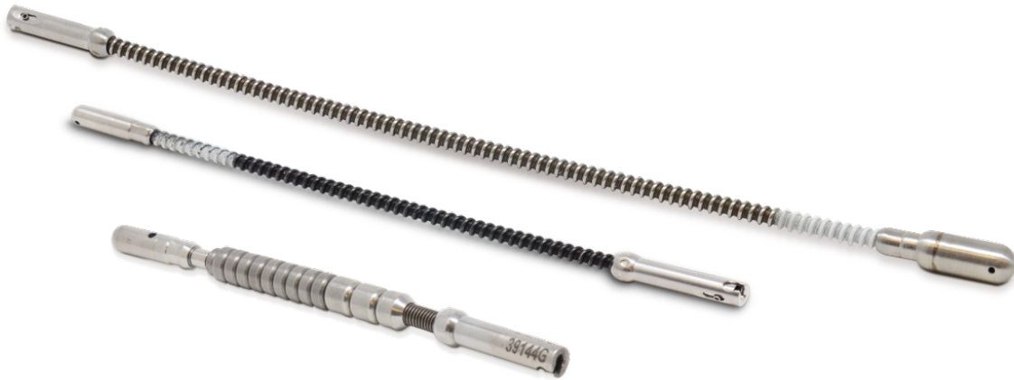
الشكل 6-1 مصادر التصوير الإشعاعي على أطراف السلاسل أو الكابلات. مصدر الكوبالت-60 على الأسلاك (الصورة في الأعلى)؛ مصدر إيريدיום-192 على الأسلاك (الصورة في الوسط)؛ ومصدر السيلينيوم-75 على التتغستن الخلفية المحمية كابل (الصورة في الأسفل). جميع المصادر من الفئة 2 إلى الفئة 3. المصدر: QSA Global, Inc.
