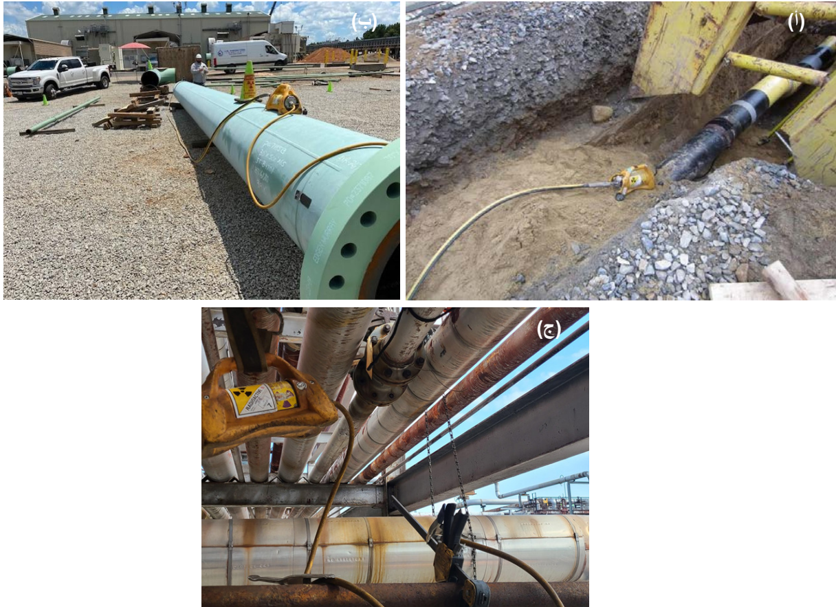
الشكل 3-6 تصوير المواقع الميدانية حيث يتم إجراء فحوصات التصوير الشعاعي عادةً: (أ) كاميرا التصوير الشعاعي (في وسط الصورة وبملصق ثلاثي الفصوص الإشعاعي) الموضوعة للفحص غير المتلف للأنبوب؛ (ب) كاميرا التصوير الشعاعي (الجزء الأيمن العلوي من الصورة) المستخدمة لفحص أنبوب؛ (ج) كاميرا تصوير إشعاعي معلقة من أنبوب لوضع أنبوب التوجيه في موقع التعرض الصحيح لصورة شعاعية للحام الأنبوب.
