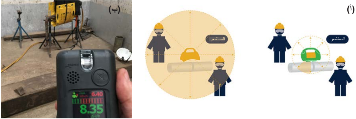
الشكل 4-6 (أ) منطقة التصوير الإشعاعي بجهاز SCAR وبدونه. مطلوب مساحة إشعاع أصغر يتم التحكم فيها عند استخدام جهاز SCAR (اللوحة اليمنى) مقارنة بالتصوير الشعاعي التقليدي (اللوحة اليسرى)؛ (ب) الجرعات تظهر ذروة القراءة من 8.35 ميكرون سيفرت/ساعة (معدل جرعة منخفضة نسبياً) لقياس حدود منطقة الحظر السلامة من الإشعاع للجهاز SCAR في العملية، وهو ما يقرب من بضعة أمتار من مقياس الجرعات. المصدر: QSA Global, Inc.
