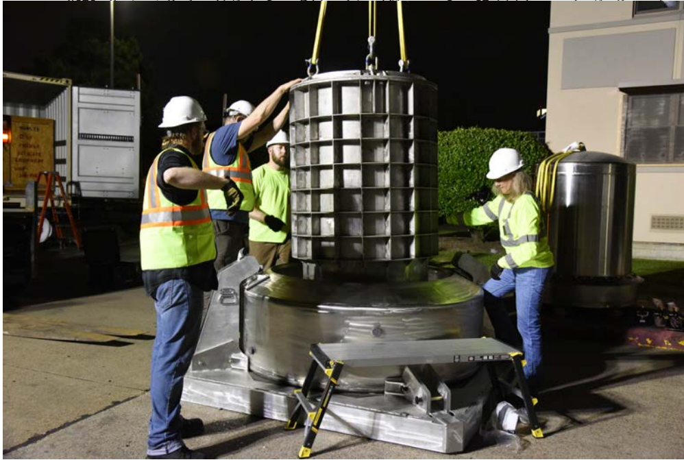
الشكل 2-4 استرداد مشع ذاتي الحماية من السيزيوم 137 باستخدام حزمة B-435 من النوع B. المصدر: وزارة الطاقة.
