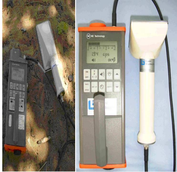
شكل (3) جهاز السافيمو (عداد غاما) المزود بكاشف يوديد الصوديوم NE Technology
